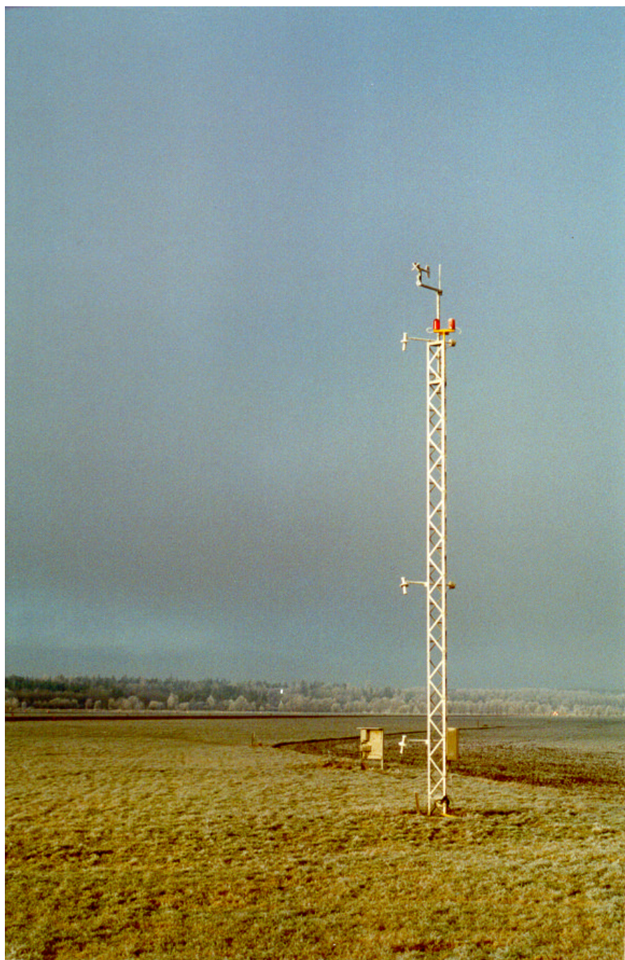
Figure 2. Mast med vind, vindriktning och temperaturmätningar
