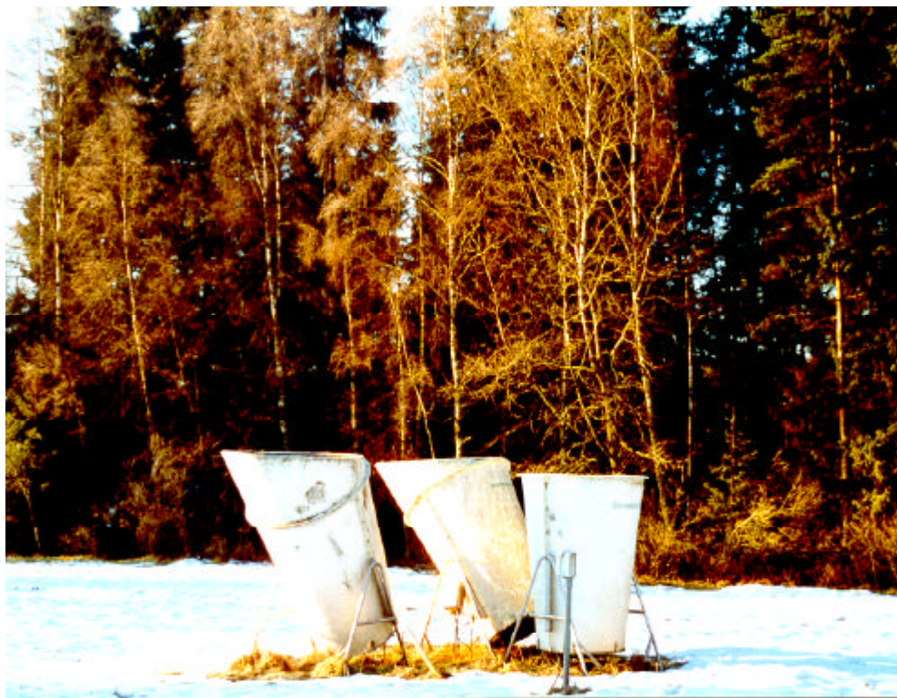
Figur 1. Sodarinstrument för beräkning av vind och vindriktning
